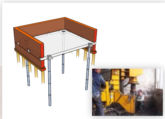
Nieuwe fundering tafelconstructie. Palen worden in woning aangebracht.
